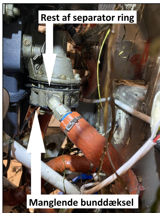
Den separerede mekaniske brændstofpumpe på motoren/flyet
